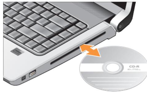
若要將光碟從光碟機退出，請輕輕觸碰退出控制鈕 。在退出光碟數秒之前，控制鈕會閃爍以確認。
